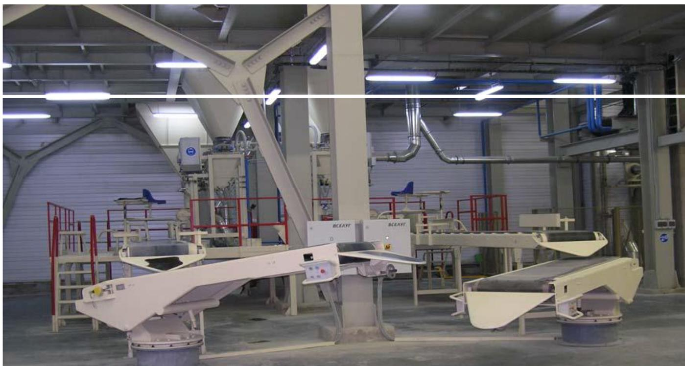
Мешкопогрузчики ВСЕЛУГ Консоль™ служат для укладки наполненных мешков на поддоны с применением ручного труда. Представляют собой шарнирно закрепленные на основании ленточные конвейеры, с механизмом поворота и механизмом подъема-опускания. Дают возможность последовательно укладывать мешки на ряд,
