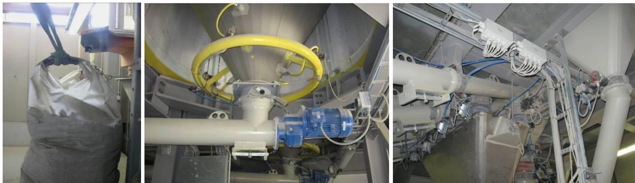
Рис. Л. 12. Крупные камневидные включения удаляются из песка при просеве, далее они транспортируются из рабочей зоны цеха в биг-бегах. Рис. Л. 13. Виброжелоб и шнековый питатель. Рис. Л. 14. Система подачи материалов.
