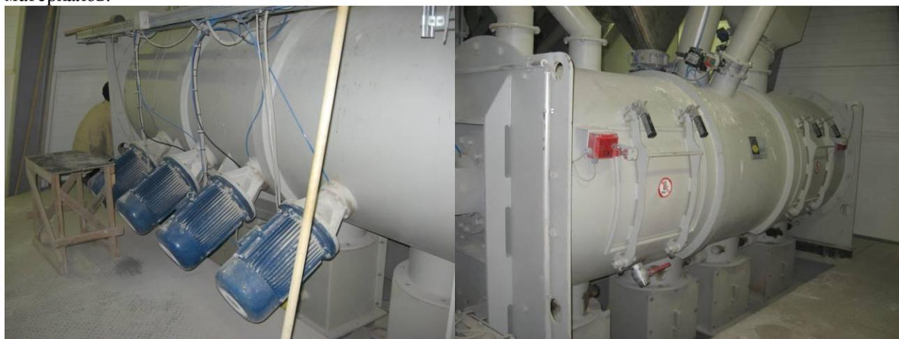
Рис. Л. 15-16. Турбосмеситель скоростной. Виды с двух сторон на турбосмеситель ССС
