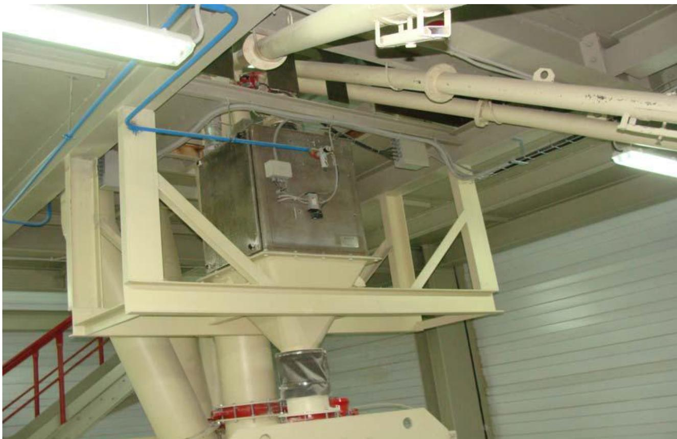
Оборудование для дозирования добавок располагается под бункерами добавок и включает в себя многокомпонентные бункерные весы (служат для поочередного
